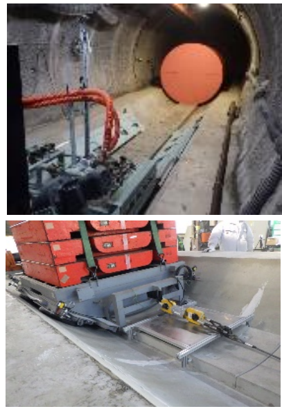
1) 搬送・定置 / 4) 回収・搬出 （エア・ベアリング駆動方式）
