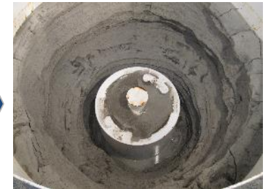
模擬オーバーパック周囲の緩衝材の除去の様子
