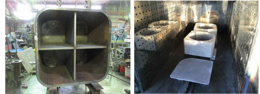
図1 廃棄体パッケージの製作性確認試験 （左：金属容器の製作、右：プレキャストセメント系充填材の乾燥）
