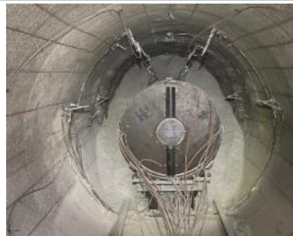
図1. HotBENTプロジェクトにおける原位置試験状況 ヒーター温度を200℃または175℃に制御し、5～10年間維持。センサーにより、熱、水理、力学、化学に関する情報を取得。加熱終了後に緩衝材及び母岩の状態を分析予定
