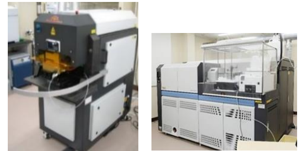
レーザーアブレーション装置(左)と ICP質量分析装置(右)
