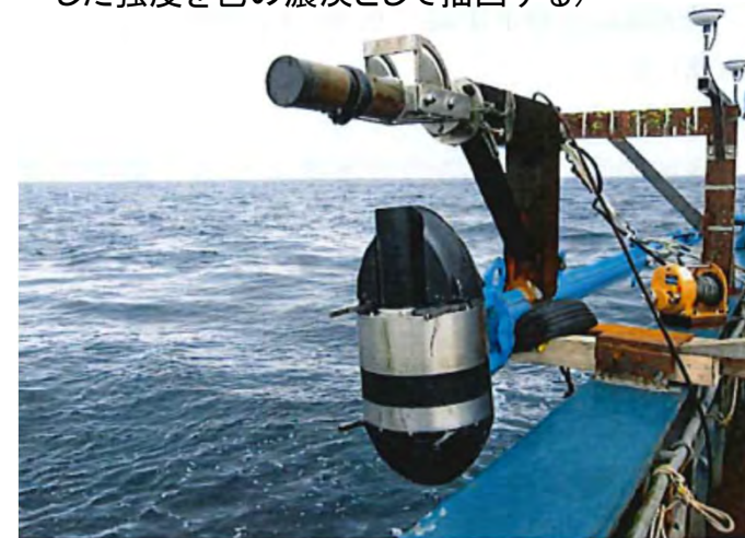
マルチビーム測深機（音波を発信し、海底で反射した音波から水深を測定する）
