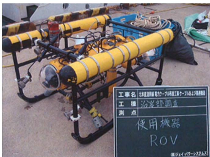
ROV (Remotely Operated Vehicle: 遠隔操作により水中を潜行できる無人潜水探査機)
