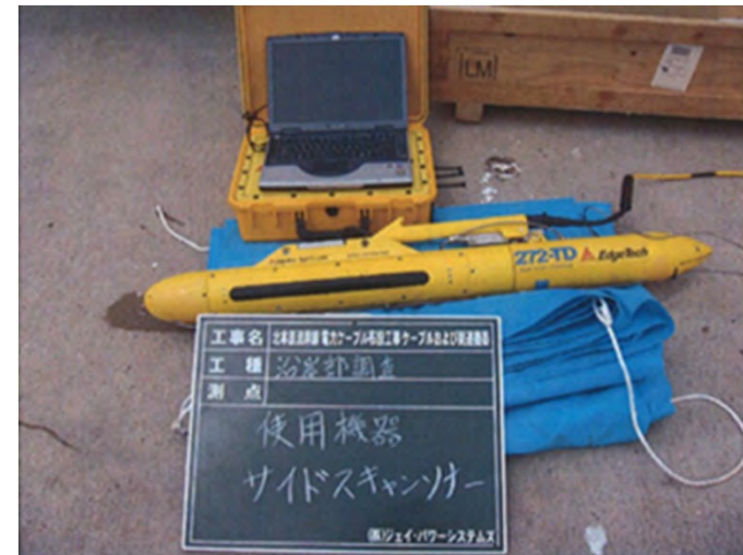
サイドスキャンソナー（音波を発信し、海底で反射した強度を色の濃淡として描画する）
