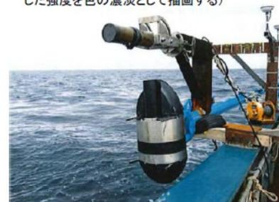
マルチビーム測深機 (音波を発信し、海底で反射した音波から水深を測定する)
