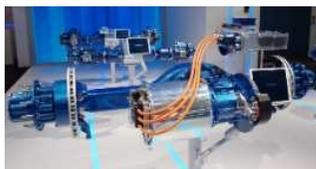
バッテリー搭載スペース確保に貢献するリアアクスルとモーター一体化した次世代駆動系の開発、走行中ワイヤレス給電に関するシステム要件の構築、燃料電池自動車における実燃費試験法の検証
