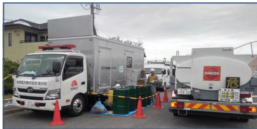
移動電源車への軽油供給(館山市)
