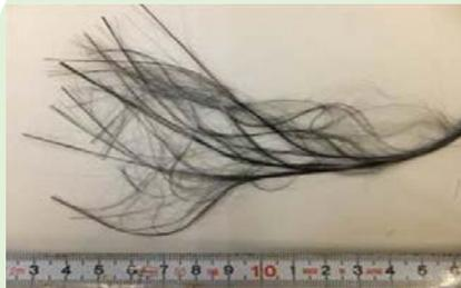
↑ 開発した炭素繊維リアクター：処理槽内に浸漬するだけでN<sub>2</sub>O大幅低減
