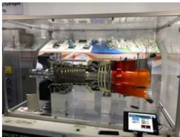
水素ガスタービン
