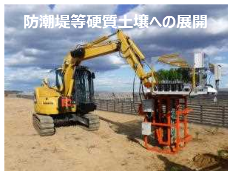
コンテナ苗 自動植栽機 硬い土壌へ完全機械化によるコンテナ苗植栽
