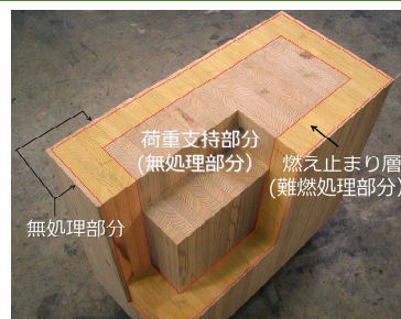
耐火集成材の断面
