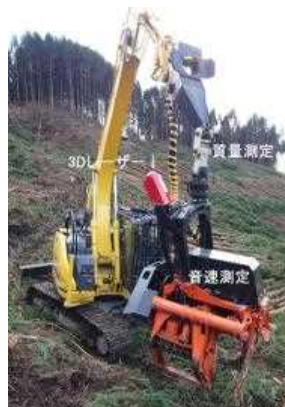
品質測定機能付きハーベスタ 丸太強度を測定し、川下と情報共有
