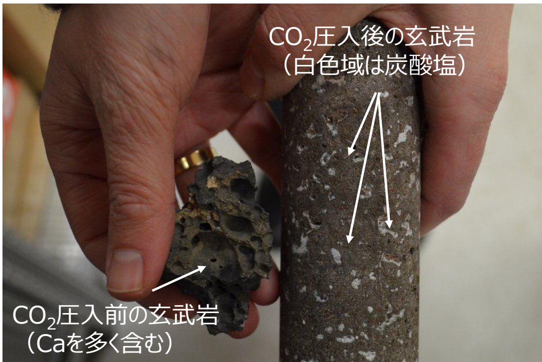
アイスランドで実施されたCarbFix CCSプロジェクトの玄武岩コアサンプル (Photo: Sandra O. Snaebjornsdottir)
