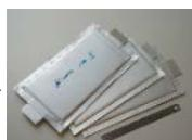
10Ah級リチウム硫黄電池の試作
