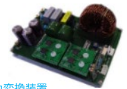
電力変換装置
