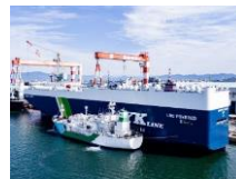
LNG/バンカリングの様子
