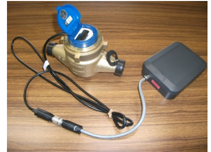
水道メーターと通信端末 接続部の防水・防塵を確保
