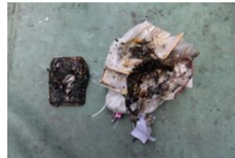
写真2 出火したモバイルバッテリーに内蔵された充電式のリチウムイオン電池
