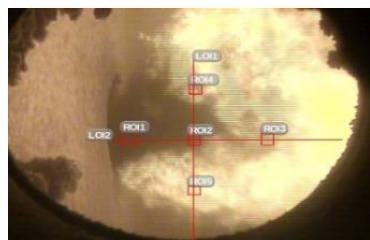
石炭・アンモニア混焼時火災
