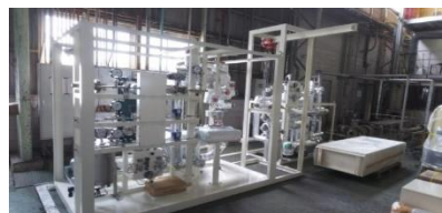
1.2Nm 3 -CH 4 /h反応装置 (IHI横浜事業所)
