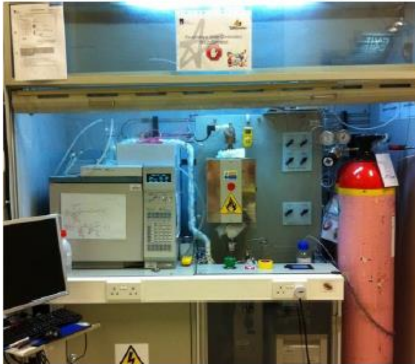
CO 2 メタネーション試験試験装置
