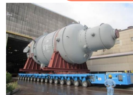
大型リアクタ (Shell & Tube) 最大実績容量 275kt/y (EO)
