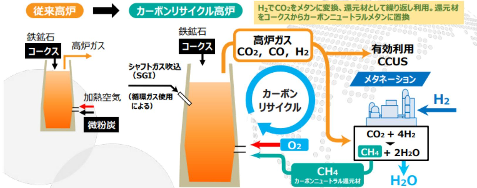
実装に向けた方針※：2030年までに純酸素都市ガス使用条件下において中規模高炉実証試験（倉敷地区、700m<sup>3</sup>規模）を実施、早期の実機実証試験・実装を検討
