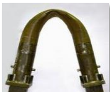
地震に強いガス管
