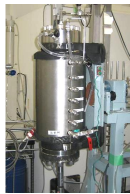
図1 小型実験装置(今回実験で使用) (試料寸法: \phi 5cm \times 10cm、1次元流れの透水実験用)
