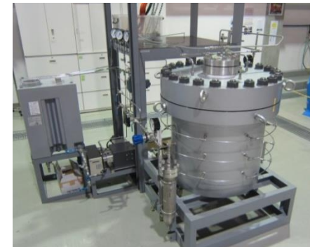
図2 中型実験装置 (試料寸法: \Phi 70\text{cm} \times 50\text{cm} )
