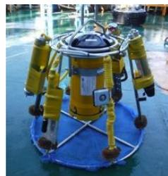
海底面から数十mまでの高さの流向と流速を計測
