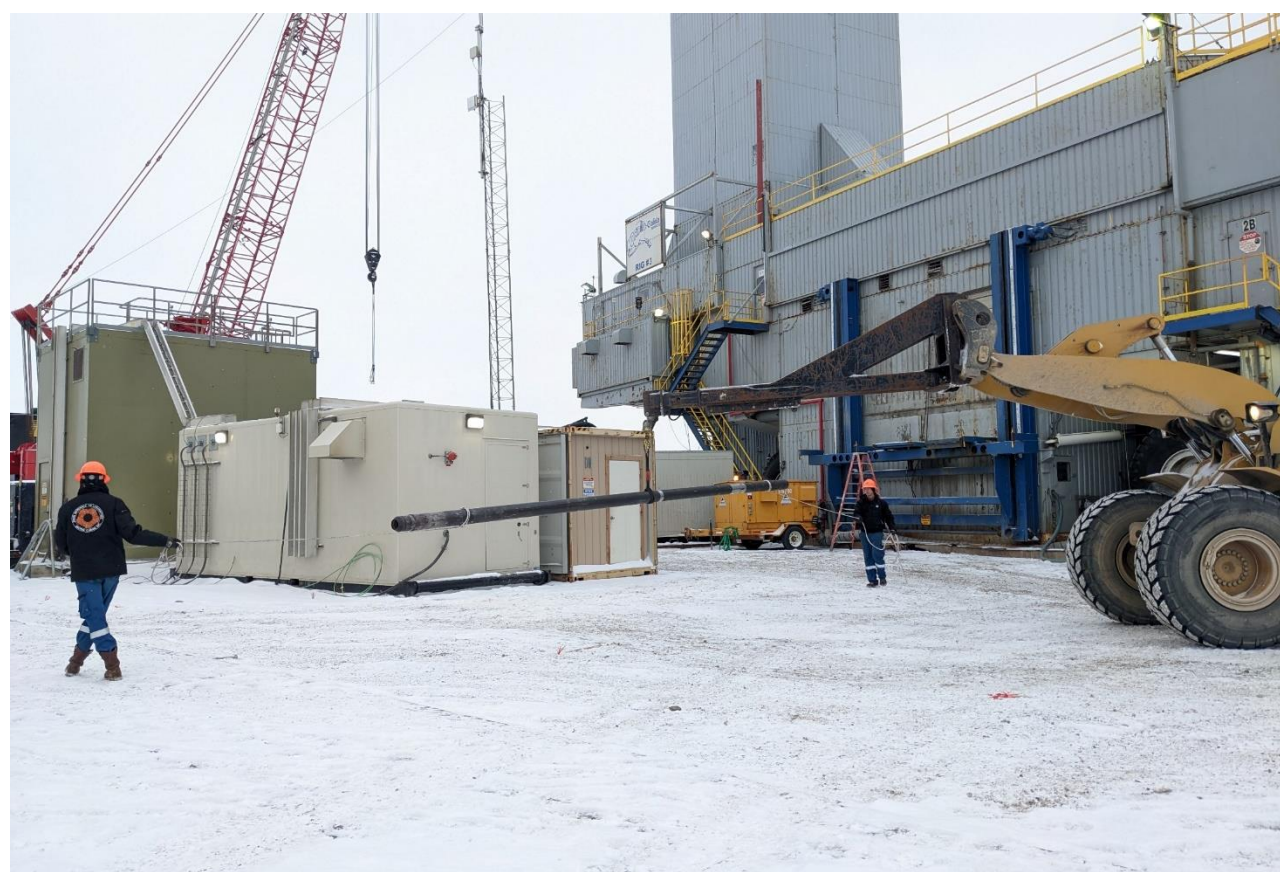
保圧コアが入ったインナーバーレルをPCATSへ PCATS: Pressure Core Analysis and Transfer System
