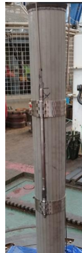
ワイヤレスPTセン サーにより初 のスクリーン外 側の温度圧力測 定に成功
