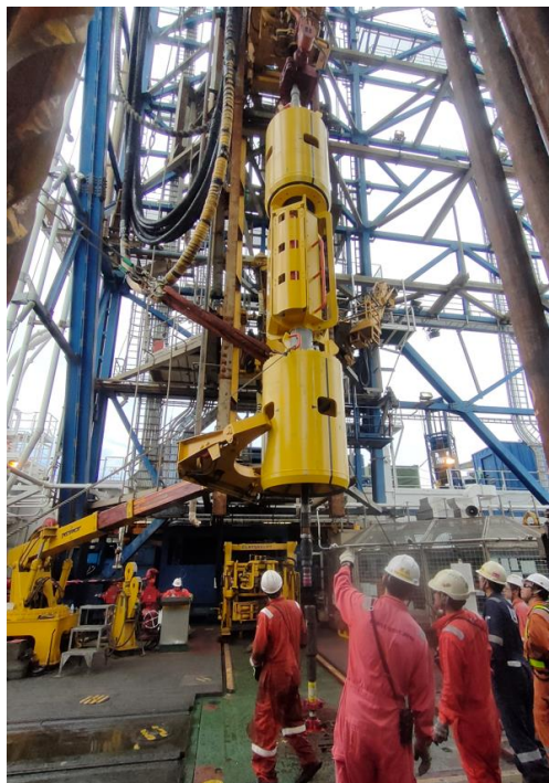
坑口切り離し装置(SDBS) 小型化し作業の効率化に 貢献
