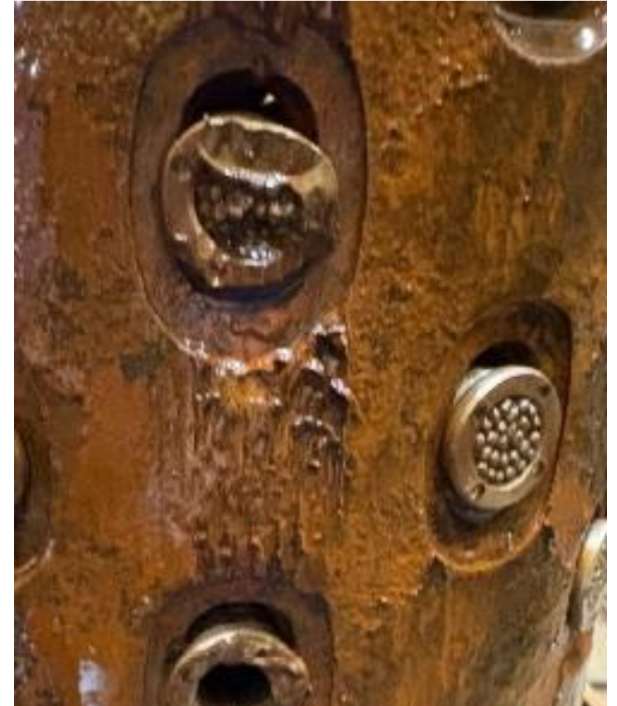
出砂対策装置引抜時の大きな引っ張り応力 によりビーズインサート穴が拡大している。 如何に出砂対策装置/ケーシング間の密着度 が大きかったことがこれでわかる。
