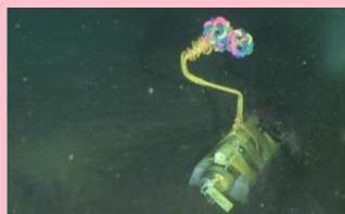
海底に設置した海底水温計
