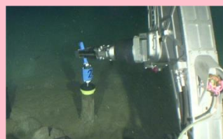
熱物性計測のための堆積物採取
