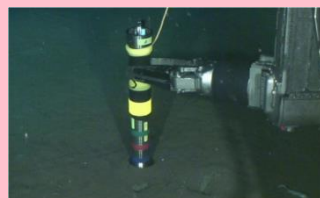
地中温度計の設置
