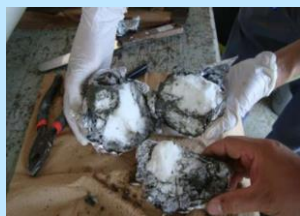
長尺ピストンコアで採取されたメタンハイドレート(2010年)
