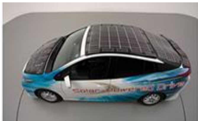
III-V族化合物太陽電池を搭載した実証車 事務局としてペロブスカイト太陽電池の搭載を想定
