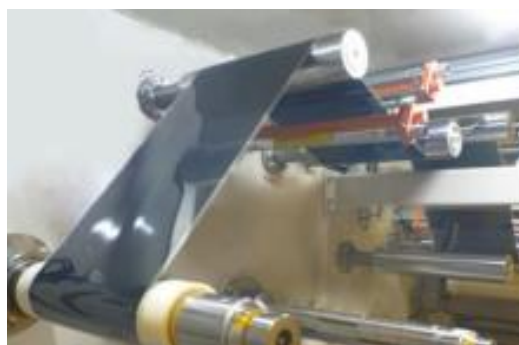
ロールtoロールでの生産
