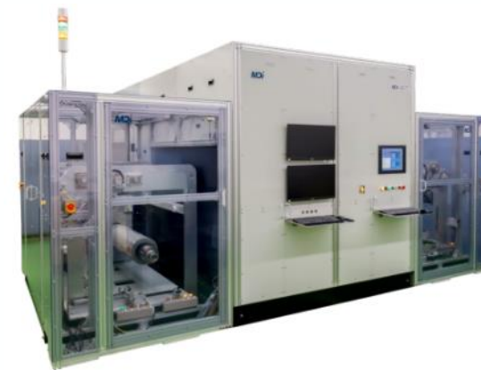
ペロブスカイト太陽電池レーザーパターニング装置の例 出所：三星ダイヤモンド工業
