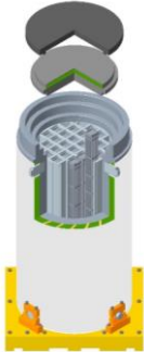
図2 乾式キャスクの構造
