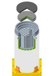
図2 乾式キャスクの構造
