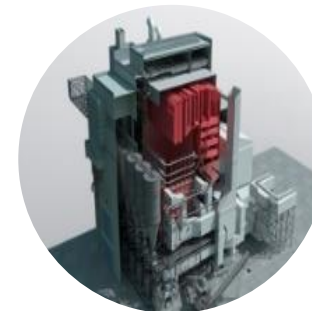
アンモニア焼きボイラ
