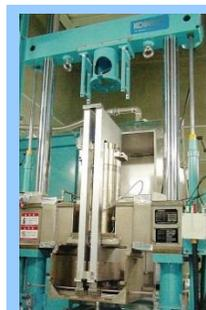
100MPa高圧水素雰囲気疲労試験機
