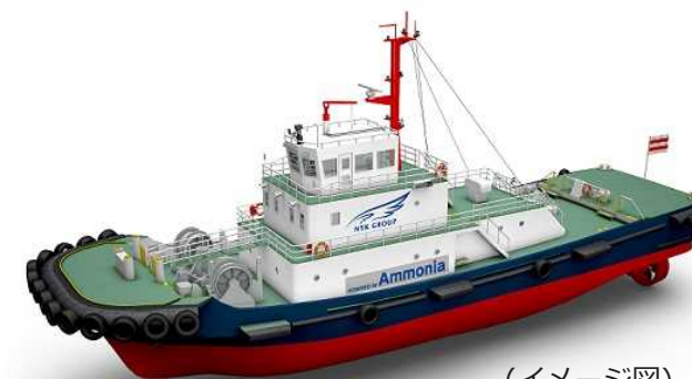
世界初アンモニア燃料タグボート船
