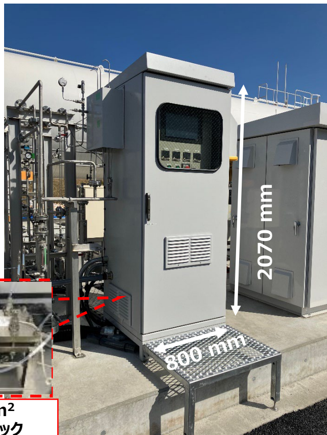
開発したセルスタックを搭載した 水電解装置外観（5 kW級、水素製造量1 Nm 3 /h）
