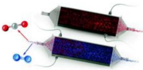
・導電ポリマーを被覆した電極のON/OFFによりCO<sub>2</sub>を吸着/分離する。
