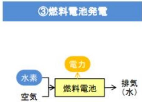
水素と酸素の化学反応から直接電力を取り出す。
