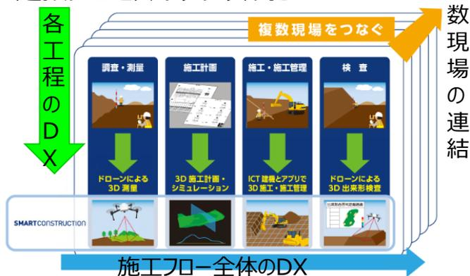
現場のドローン測量等でデジタルツインを構築し、計画から管理までの前後工程の見える化が図られることで、工程間のシナジー創出、必要資材やリソース及びオペレーションの全体最適化を実現。
