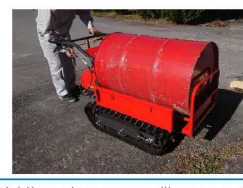
少人数での作業効率向上のため、中和剤貯蔵タンク投入用輸送設備を設置。中和剤20トン（約4週間分）をフレコンバッグで備蓄。また、重量物運搬用のキャリアダンプを配備。
