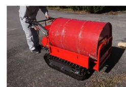
少人数での作業効率向上のため、中和剤貯蔵タンク投入用輸送設備を設置。中和剤20トン（約4週間分）をフレコンバッグで備蓄。 また、重量物運搬用のキャリアダンプを配備。
