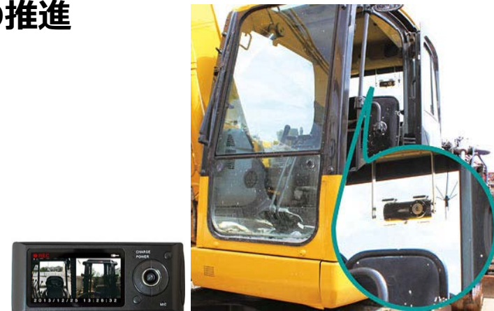
建設重機へのドライブレコーダ設置事例イメージ
