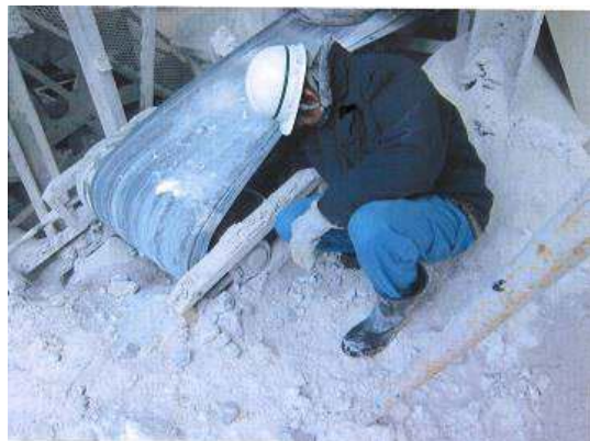
30年1月の巻き込まれ状況（再現） 【ベルト幅66cm】
