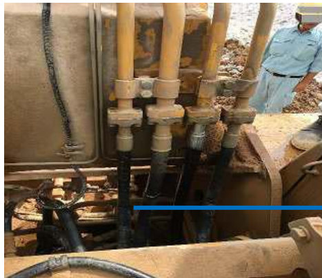
※ 30年9月 火災重機の油圧ホース(右は拡大)
