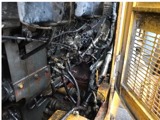
※ 30年11月 火災重機のエンジンルーム
