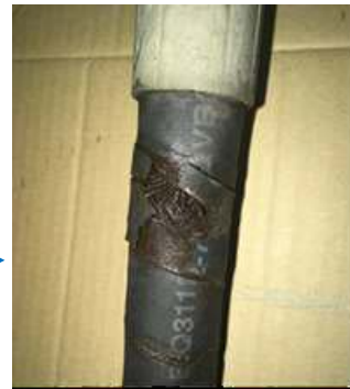
※ 30年9月 火災重機の油圧ホース(右は拡大)
