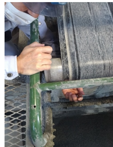
31年1月の巻き込まれ状況（再現） 【ベルト幅50cm】
