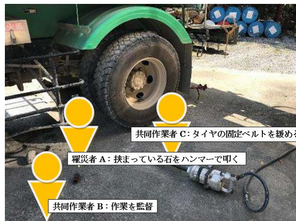
作業員の作業位置
