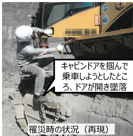
重機からの墜落（令和2年8月）
