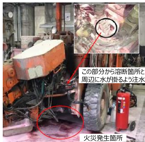
溶断作業中に水と間違えて灯油を掛け出火（令和2年10月）
