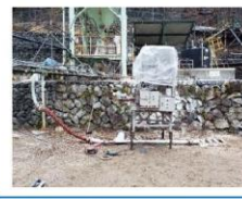
少人数での作業効率向上のため、中和剤貯蔵タンク投入用輸送設備を設置。中和剤20トン（約4週間分）をフレコンバッグで備蓄。また、重量物運搬用のキャリアダンプを配備。
