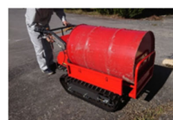
少人数での作業効率向上のため、中和剤貯蔵タンク投入用輸送設備を設置。中和剤20トン（約4週間分）をフレコンバグで備蓄。また、重量物運搬用のキャリアダンプを配備。
