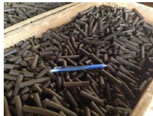
製造直後の脱硫化水素剤
