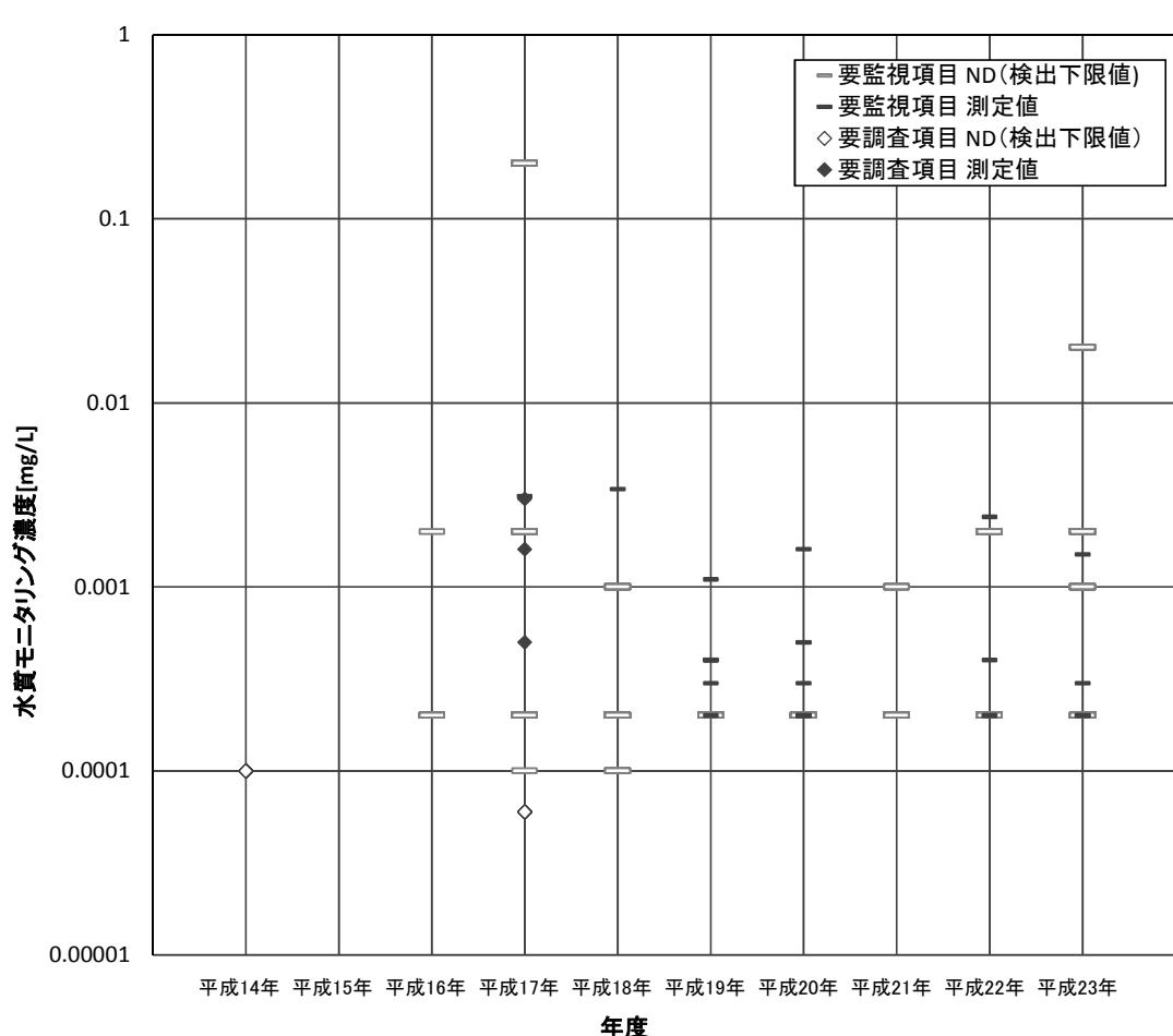
図 5-2 クロロエチレンの過去 10 年間の年度別水質環境モニタリング調査結果(要監視項目及び要調査項目)のプロット図
