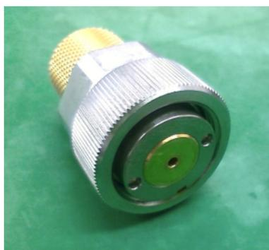
図2 標準終端器群： 標準短絡終端器
