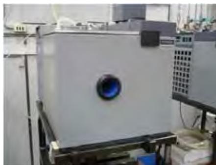
図1 標準黒体炉装置
