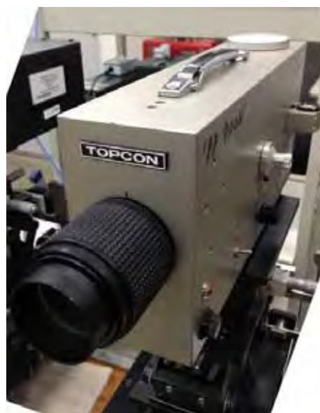
写真2 単色放射温度計 ( 0.65 \mu\text{m} 、0.9 \mu\text{m} )
