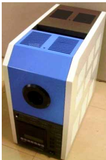
写真1 定点実現装置 ( 亜鉛点、アルミニウム点、銀点、銅点 )
