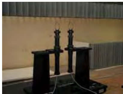
図3 特定標準器の3アンテナ法による校正概念図と校正校正風景写真
